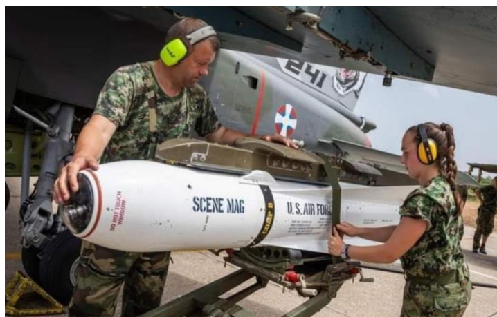
Наоружавање авиона Ј-22 „Орао“ вођеном ракетом АМГ-65 „Maverick“
