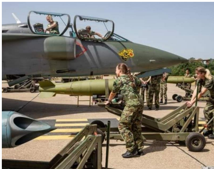
Наоружавање авиона J-22 „Орао“ авио бомбом ФАБ-250
